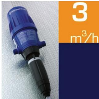
Doseerpomp voor het toevoegen van polyfosfaten in het drinkwater. Dit verhindert corrosie en kalksteenvorming. Het voorkomt dat corrosiedeeljes en vuilheid van oude buizen meestromen met het drinkwater. Aandrijving door waterdoorstroming en druk. Proportionele doseertechniek zonder electriciteit. Automatische geïntegreerde menging
